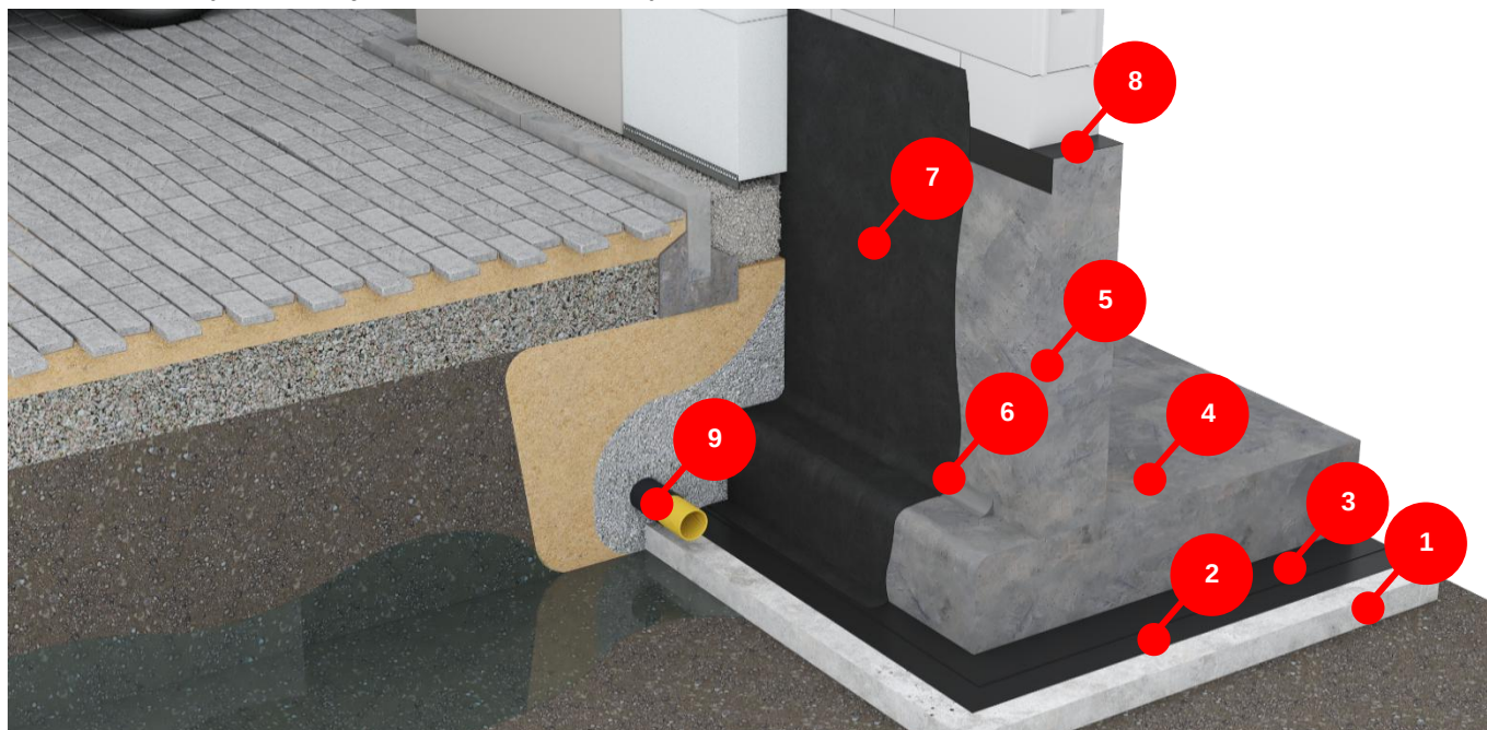
Rysunek 1. Hydroizolacja fundamentów z użyciem MATIZOL EVOMER 1K RESIST
